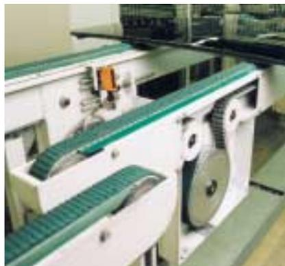
Transport von PKW-Scheiben mittels Synchronantrieb. Die Beschichtung der Zahnriemenrücken schützt das Fördergut und verbessert die Mitnahmeeigenschaften.
