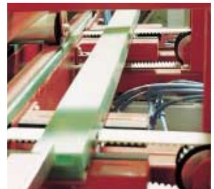
ProPosition Zahnriemen in der Vertikalachse eines Industrieroboters.
