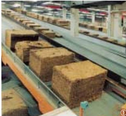
① Ballentransport: Extreme Punktbelastung im Stop and Go-Betrieb.
