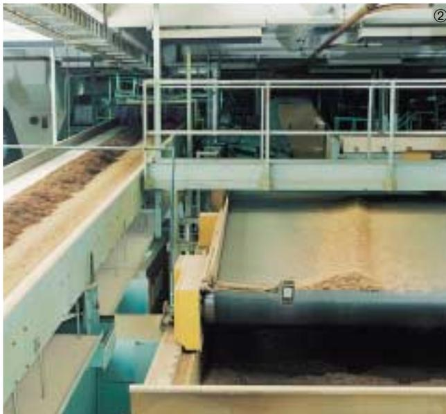
② Horizontaltransport auf einem Shuttle zum Befüllen der Staubox.
