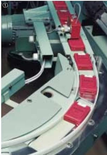
② Zum Transport von Zigaretten-schachteln oder -stangen lassen sich mit Transilon-Rundriemen auch komplizierte Förderstrecken einfach realisieren.
